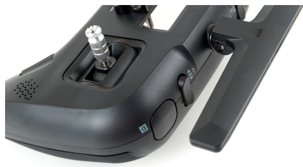
Drehschalter, Einschalter, Anschlüsse und Lautsprecher
